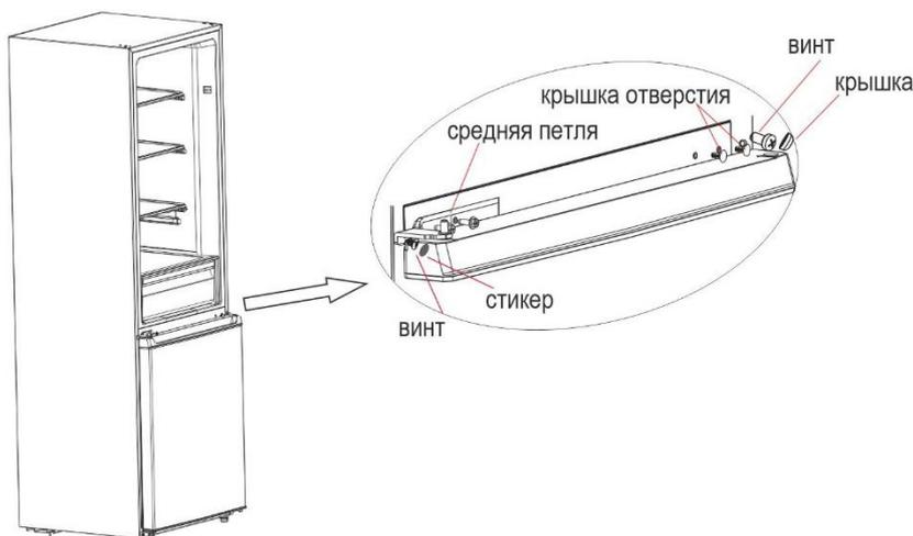
Снимите нижнюю заглушку, втулку и отверстие крышки холодильной двери и установите ее с другой стороны. Поместите холодильную дверь на среднюю петлю и установите верхнюю петлю. Установите верхнюю крышку шарнира и крышку отверстия.
