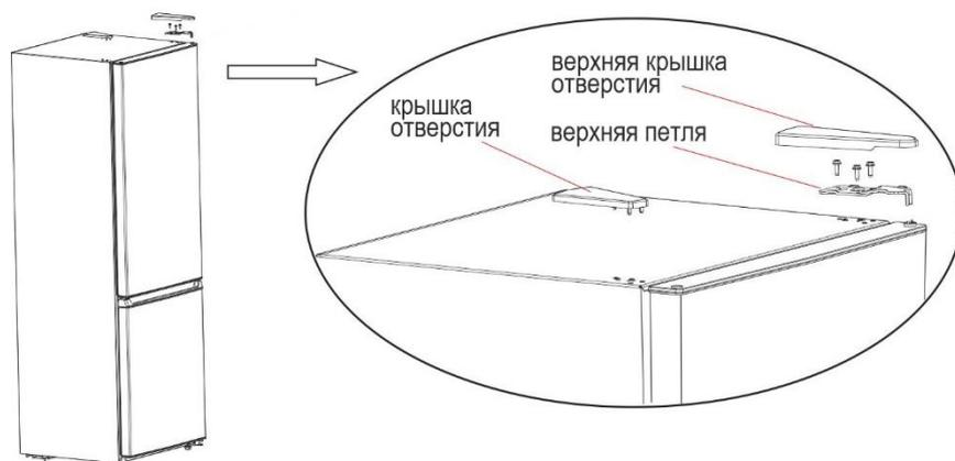
Снимите дверцу холодильной камеры, а также среднюю петлю, винты, крышку винта, наклейку и крышку отверстия.
