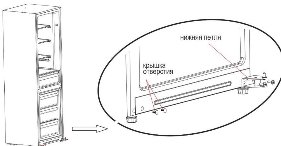
Установите втулку нижнего шарнира и нижний шарнир с другой стороны. Снимите нижнюю заглушку, втулку, стопорный винт (и дверную опору) двери морозильной камеры и установите ее с другой стороны. Далее снимите втулку трубы и колпачки отверстий на дверце морозильной камеры и установите ее с другой стороны.
