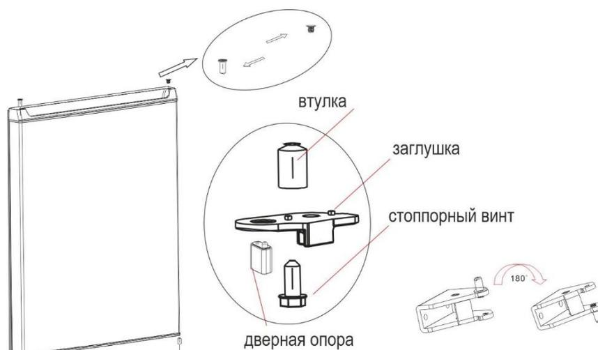
Поместите морозильную дверь на нижнюю петлю и установите среднюю петлю, винты, крышку винта, наклейку и крышку отверстия.
